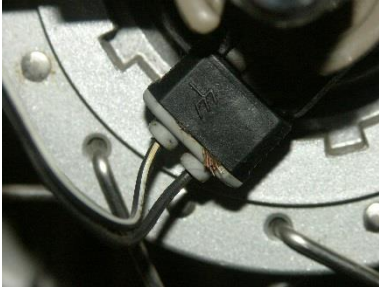
1) Stecker an Vorderachse finden
