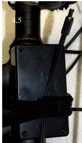
5. Nun können Sie den Harvester einhängen. Fädeln Sie das Klettband in die Lasche desselben ein und befestigen Sie damit auch das Dynamokabel, um eine Zugentlastung des Kabels am Harvester zu erreichen.
