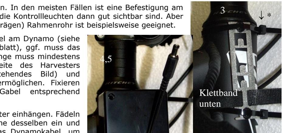
4. Montieren Sie nun das Kabel am Dynamo (siehe Anleitung im Harvester-Datenblatt), ggf. muss das Kabel gekürzt werden. Die Länge muss mindestens einige cm über die Oberseite des Harvesters hinausragen (siehe nebenstehendes Bild) und sämtliche Lenkbewegungen ermöglichen. Fixieren Sie das Kabel an der Gabel entsprechend (Kabelbinder 10cm).
